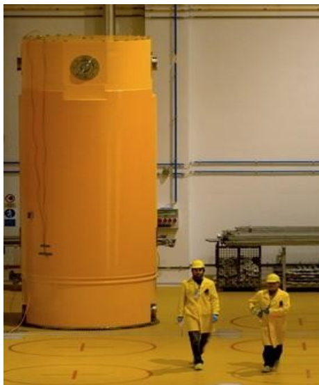
CASTOR - 5,5 m vysoký kontejner pro uskladnění vyhořelého jaderného paliva. Váha kontejneru při naplnění: 116 tun, uvnitř 20 tun vyhořelého paliva.
